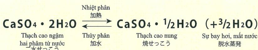
Thạch cao có công thức Canxi Sulphat ( $\text{CaSO}_4$ ) ngậm hai phân tử nước, bị nhiệt phân dưới nhiệt độ  $120^\circ\text{C} \sim 150^\circ\text{C}$  sẽ mất 75% nước và trở thành bột thạch cao nung.
